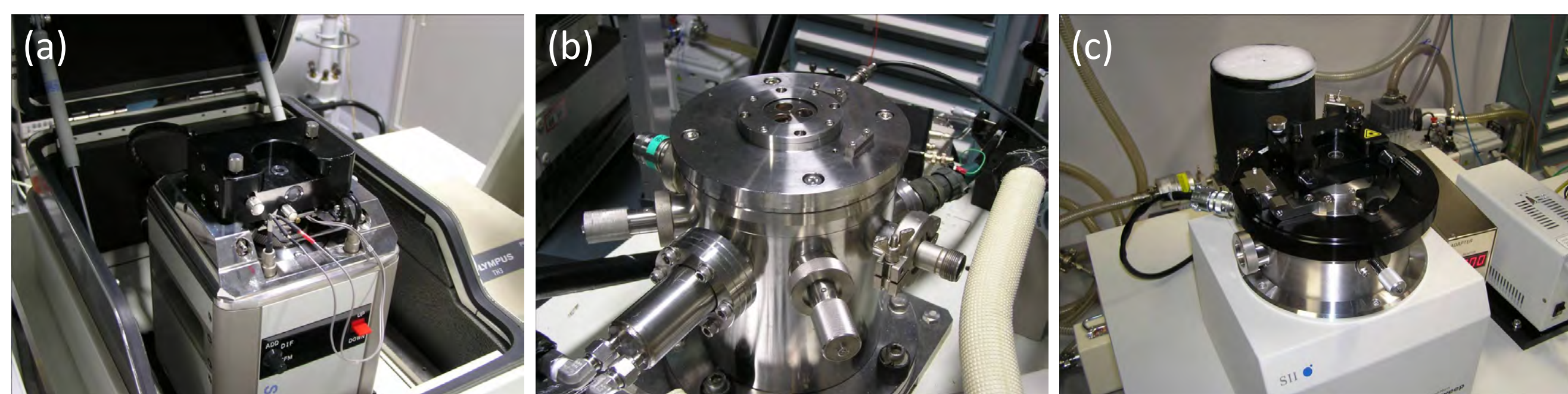
多機能SPMユニット : (a) 大気型, (b)(c) 温度可変高真空型
