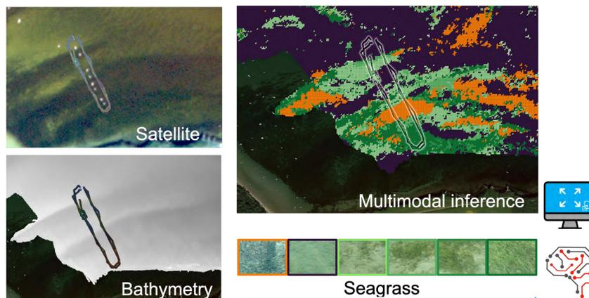
ロボットの現場観測とリモートセンシングの統合解析で広範囲に海底空間の理解を拡大
