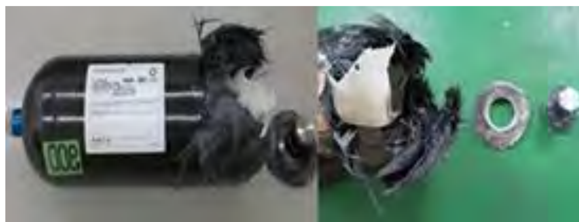
容器破裂試験によるシミュレーションの検証
