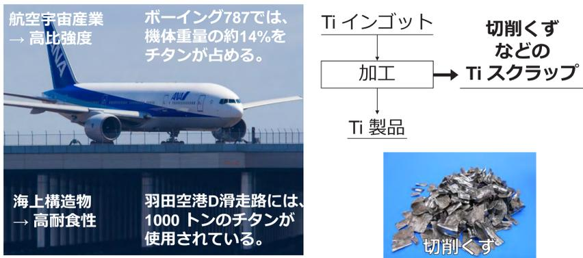
チタン (Ti) インゴットの加工工程で発生する Ti スクラップは、**酸素不純物に汚染されており、インゴットへのリサイクルが困難**
