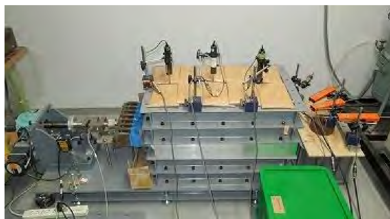
液状化発生前後の地盤強度の変化と中空供試体による液状化実験
