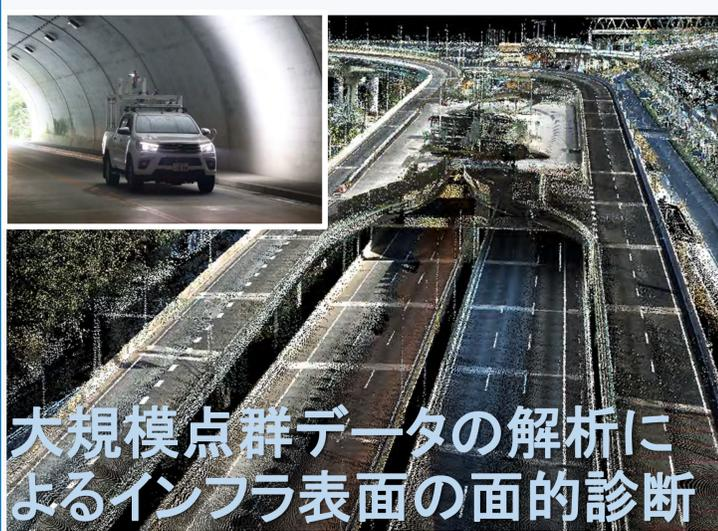
大規模点群データの解析によるインフラ表面の面的診断
