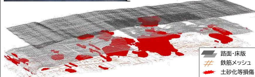
スマートフォン搭載ハンディレーダーを用いた構造物内部クラックの高精度定量評価
