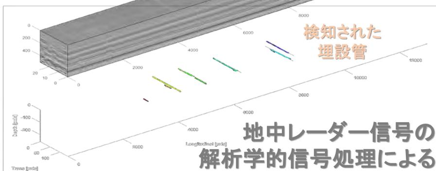
地中レーダー信号の解析学的信号処理による埋設管のセグメント抽出とマッピング
