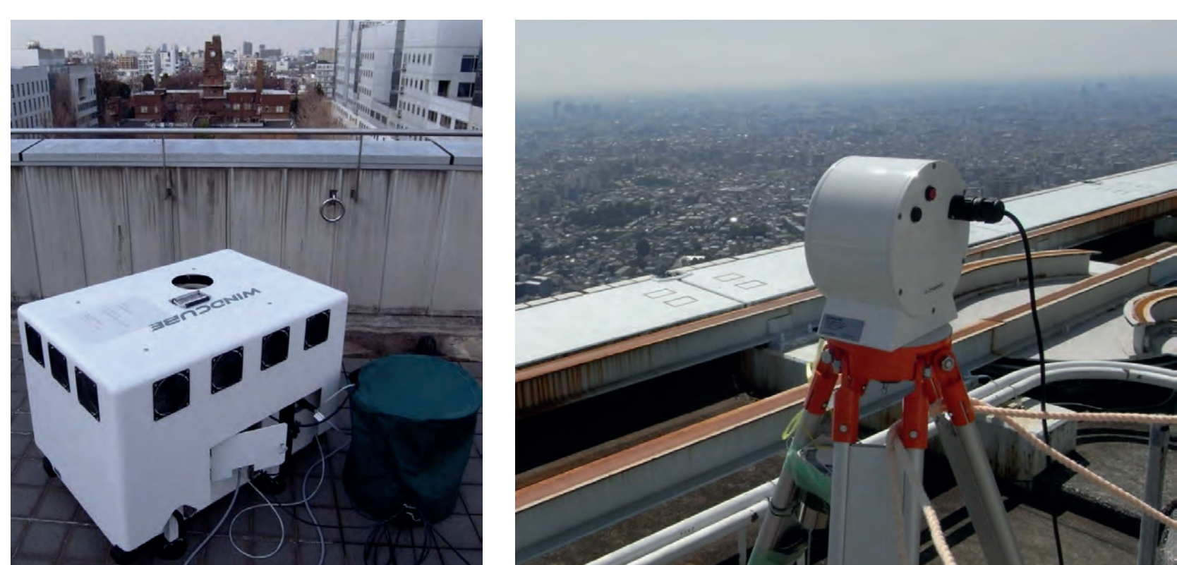
■ ドップラーライダーを用いた風速実測 ■ シンチロメータを用いた都市域の顕熱フラックス実測
