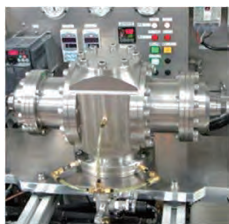
無振動なクロスバランス機構を採用した気液二相レシプロ膨張機
