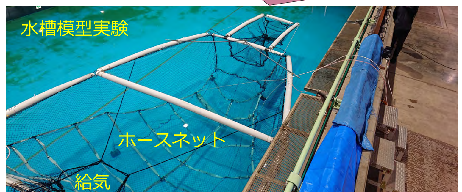
定置漁業自動魚群誘導化システム 揚網作業の省力化を目指しています。
