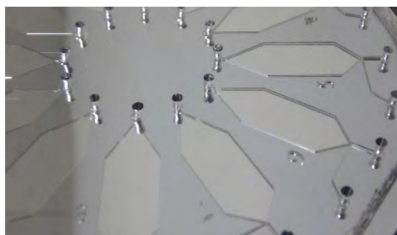
微生物DNA精製用マイクロ流体デバイス (金研究室と共同)
