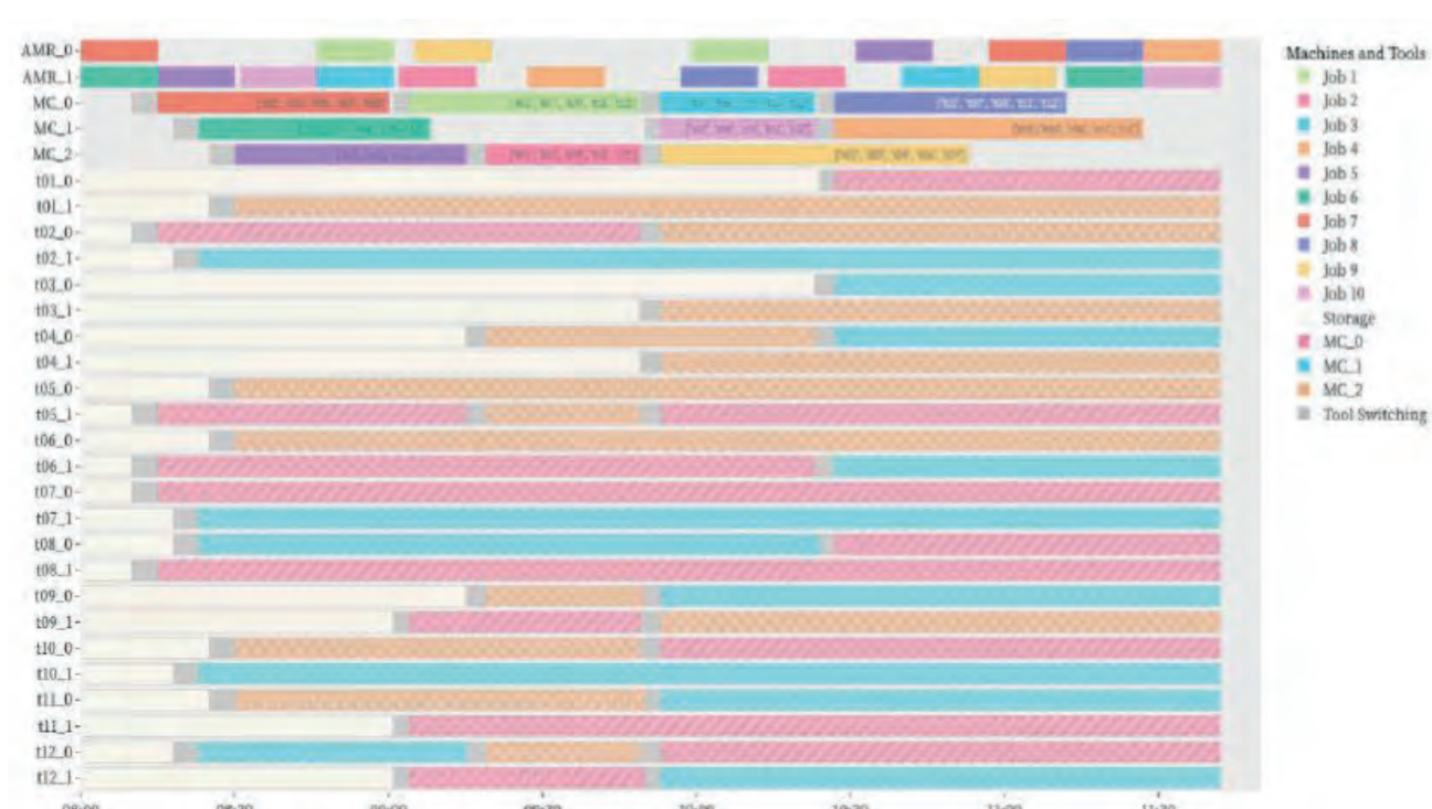
図4. 8 CQM_1appによるFMS加工工程のスケジューリング結果の例
