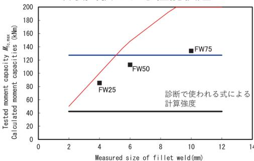
溶接サイズの小さい旧基準鉄骨造柱梁接合部は溶接破断で耐力が決定、ただし耐震診断で使われる式による計算強度の倍以上の強度を発揮
