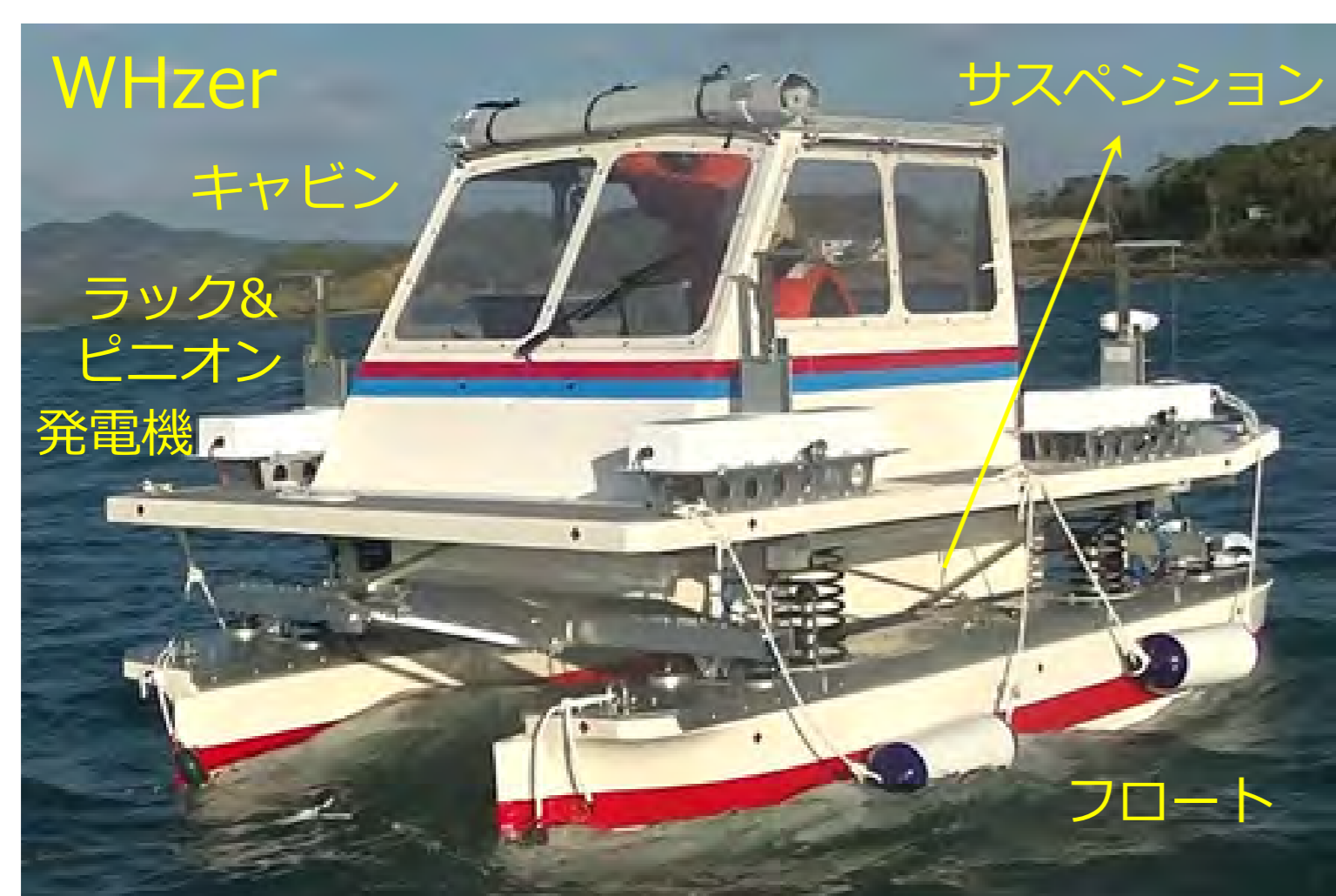
Wave Harmonizer (山口県油谷湾・神奈川県平塚沖) 小型船で波エネルギーを収穫して乗り心地を向上しました。
