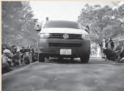
FWDによる陥没試験
