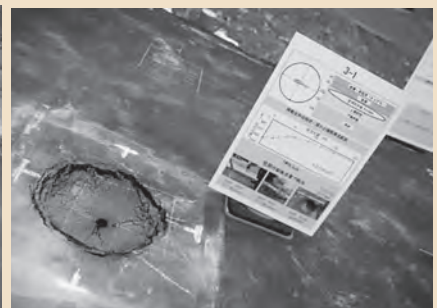
生成後24時間で陥没に至った浅い空洞
